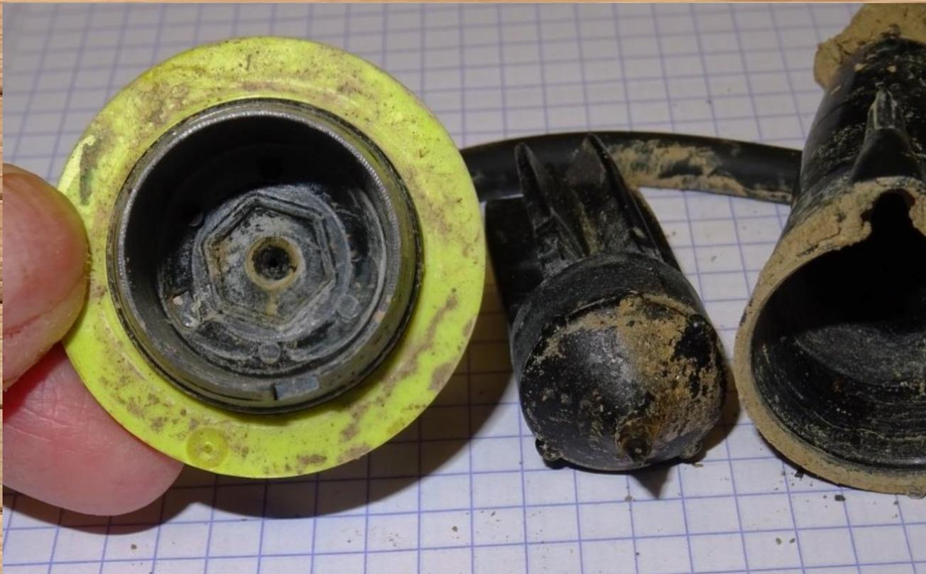
Un biofilm et des particules se déposent dans les systèmes classiques.
